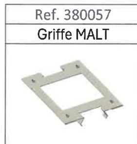
Cet élément permet d'effectuer la liaison équipotentielle des masses entre les cadres des modules photovoltaïques adjacents et les rails support. Il vient s'insérer dans la gorge supérieure du rail support, et vient griffer le cadre du module et le rail lors du bridage par les étriers.
