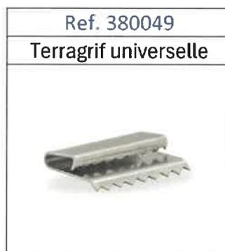
Cet élément permet d'effectuer la liaison équipotentielle des masses entre le cadre des modules photovoltaïques et les rails support. Il vient s'insérer dans le retour de cadre du module, et vient griffer le rail lors du bridage par les étriers ou les Miniclamps.
