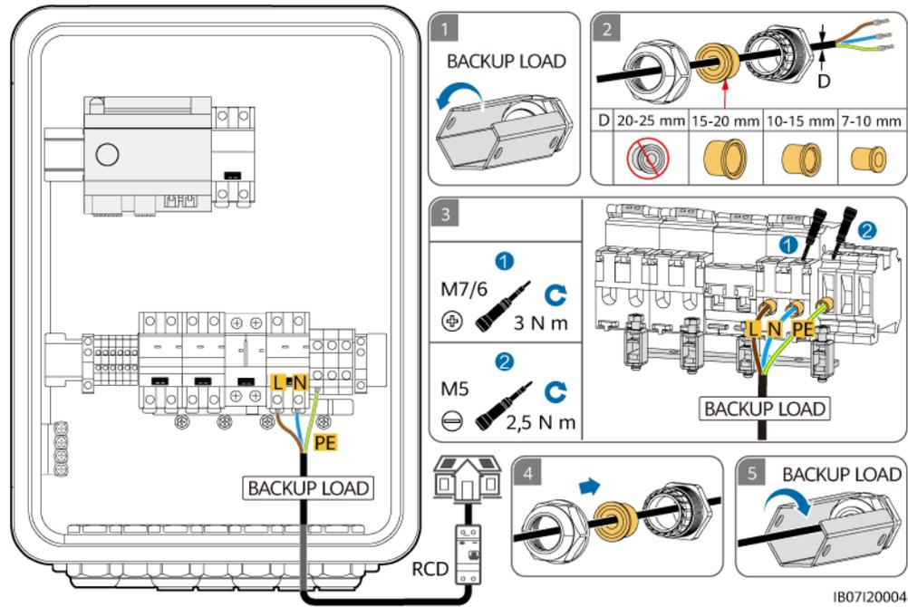
**Figure 5-15** Connexion du câble d'alimentation de la charge de secours du SmartGuard-63A-AUS0
