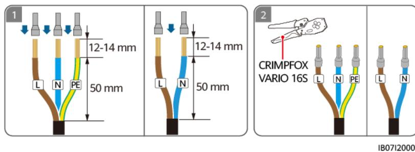
**Étape 3** Connectez le câble d'alimentation de sortie CA du réseau.
