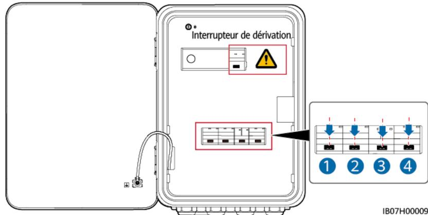
2. Retirez le loquet de l'interrupteur de dérivation, mettez sous tension l'interrupteur de dérivation, puis mettez sous tension les interrupteurs 1 et 4 figurant dans la figure.
