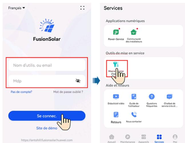
**Étape 2** Connectez-vous à l'onduleur solaire WLAN en tant qu'**installateur** pour accéder à l'écran Mise en service de l'appareil.
