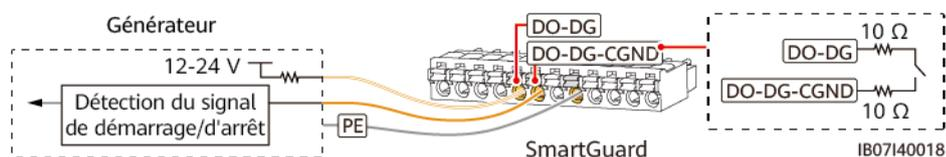
**Figure E-2** Signal d'alarme du générateur
