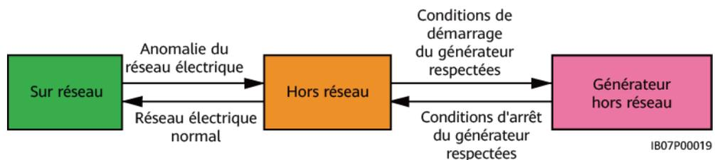
Tableau 2-5 Basculement des modes de fonctionnement
