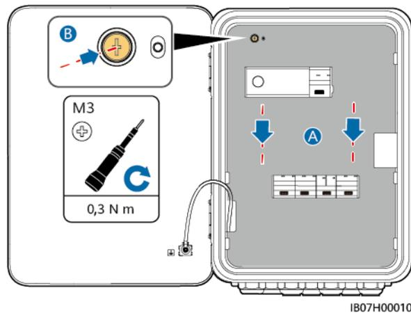
**Étape 2** Avant de fermer la porte du compartiment de maintenance, allumez les trois commutateurs illustrés dans la figure suivante (en utilisant la connexion à l'onduleur LC0 comme exemple). Lors du déploiement et du fonctionnement normal, n'opérez pas le commutateur de dérivation illustré dans la figure.
