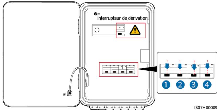
**Étape 3** Retirez la vis du couvercle du compartiment de maintenance et ouvrez le couvercle.
