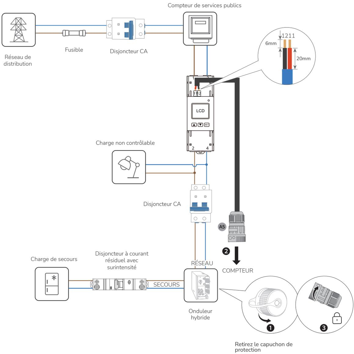
(Facultatif) Raccordement du compteur communicant triphasé au PowerOcean et à un onduleur d'une autre marque
