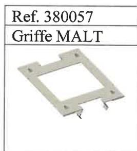
Cet élément permet d'effectuer la liaison équipotentielle des masses entre les cadres des modules photovoltaïques adjacents et les rails support. Il vient s'insérer dans la gorge supérieure du rail support, et vient griffer le cadre du module et le rail lors du bridage par les étriers.
