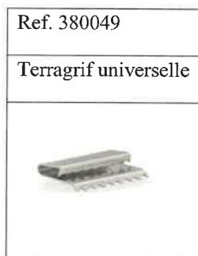
Cet élément permet d'effectuer la liaison équipotentielle des masses entre le cadre des modules photovoltaïques et les rails support. Il vient s'insérer dans le retour de cadre du module, et vient griffer le rail lors du bridage par les étriers.
